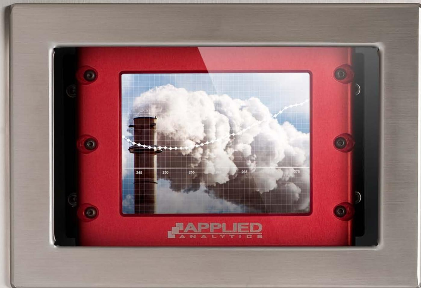
Une fenêtre sur votre procédé depuis 1994. Par l'entremise de l'analyse optique en continu, le modèle OMA traduit le spectre d'absorbance par ultraviolet visible (UV-Vis) et par infrarouge de courte longueur d'onde (SW-NIR) d'un liquide et rend sa composition chimique et ses propriétés physiques en temps réel.
